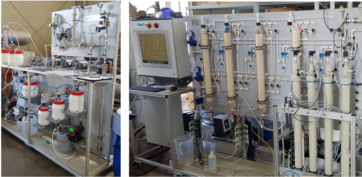
Figure 15 : (à gauche) Installation pilote d'extraction du lithium, unité de prétraitement de la saumure. (à droite) Installation pilote d'extraction du lithium, unité DLE.
