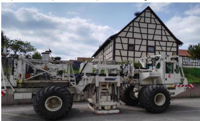
Figure 11 : (à gauche) Source sismique de type camion vibreur Mertz-26 d'une puissance de 276 kN (Source : (Richard et al. 2019)), (à droite) exemples de capteurs sismiques. (Source : Sercel)
