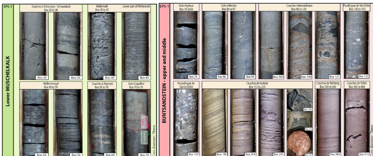
Figure 94 : Exemple de carottes du Muschelkalk et du Buntsandstein issues du forage exploratoire EPS-1 (Soulz-sous-Forêts). (Source : (Aichholzer et al. 2019))
