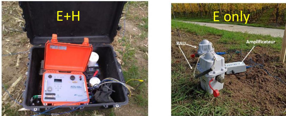
Figure 38 : Équipements d'acquisition des données électriques et magnétiques, respectivement une base dite ADU (à gauche) et une base RAU (à droite). (Source : (Darnet et al. 2021))
