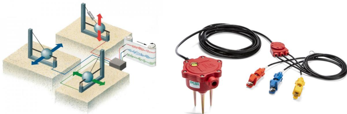
Figure 64 : (à gauche) Schéma explicatif de l'orientation des 3 composantes d'un signal sismique (Source : British Geological Survey). (à droite) Exemple d'un capteur analogique 3 composantes (Source : Constructeur Pasi).
