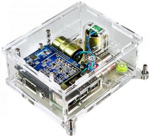
Illustration n° 6 : Capteur sismologique de type Raspberry Shake 3C pour un déploiement en intérieur et à but éducatif.
