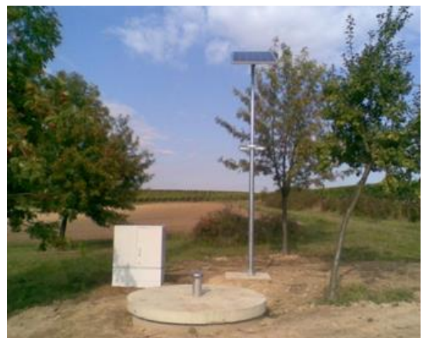
Illustration n° 7 Exemple de stations temps-réel. A gauche pour le monitoring de la centrale de Rittershoffen (Source : (Ravier et al., 2016) et à droite pour le monitoring de la centrale d'Insheim (Source : (Küperkoch et al., 2016)).
