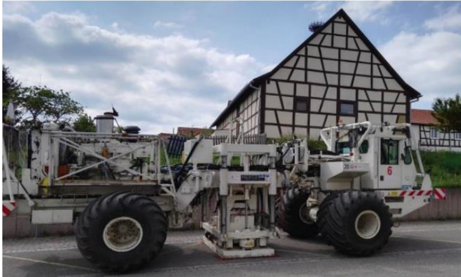
Illustration n° 10 : Source sismique de type camion vibreur Mertz-26 d'une puissance de 276 kN. (Source : (Richard et al., 2019).
