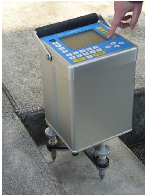
Illustration n° 13 : Exemple d'un gravimètre Autograv CG-5. (Source : Wikipédia).
