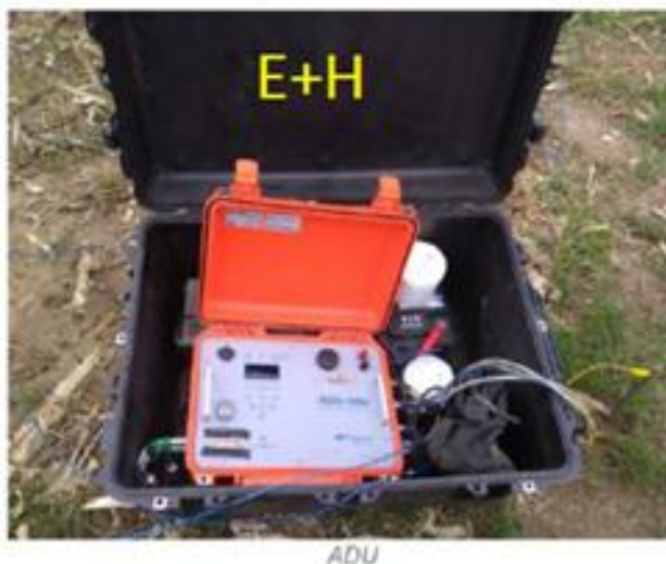
Illustration n° 11 : Exemple d'équipements pour une campagne CSEM, à gauche une stations MT et à droite une station CSEM. (Source : (Darnet et al. , 2021).
