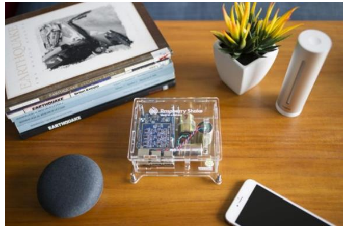
Illustration n° 6 : Capteur sismologique de type Raspberry Shake 3C pour un déploiement en intérieur et à but éducatif.
