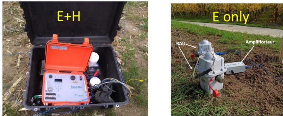
Figure 16 : Équipements d'acquisition des données électriques et magnétiques, respectivement une base dite ADU (à gauche) et une base RAU (à droite). (Source : (Darnet et al. 2021))
