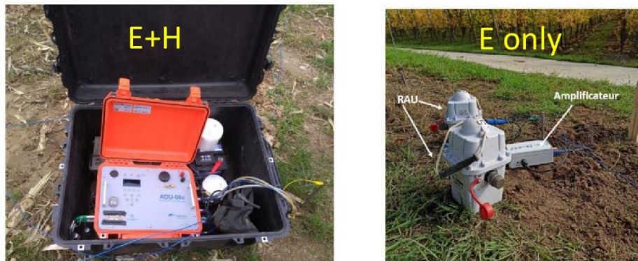
Figure 32 : Équipements d'acquisition des données électriques et magnétiques, respectivement une base dite ADU (à gauche) et une base RAU (à droite). (Source : (Darnet et al. 2021))
