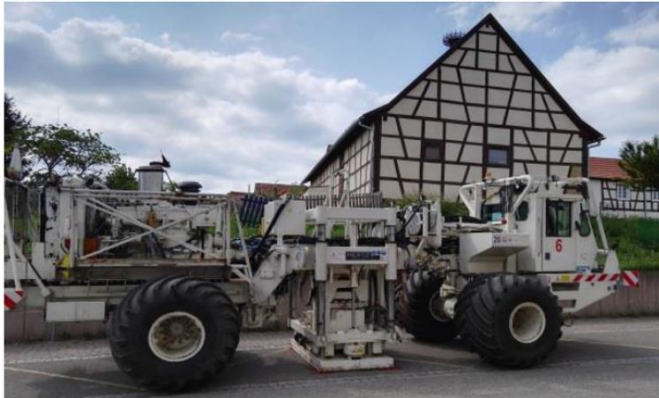
Figure 30 : (à gauche) Source sismique de type camion vibreur Mertz-26 d'une puissance de 276 kN (Source : (Richard et al. 2019)), (à droite) exemples de capteurs sismiques. (Source : Sercel)
