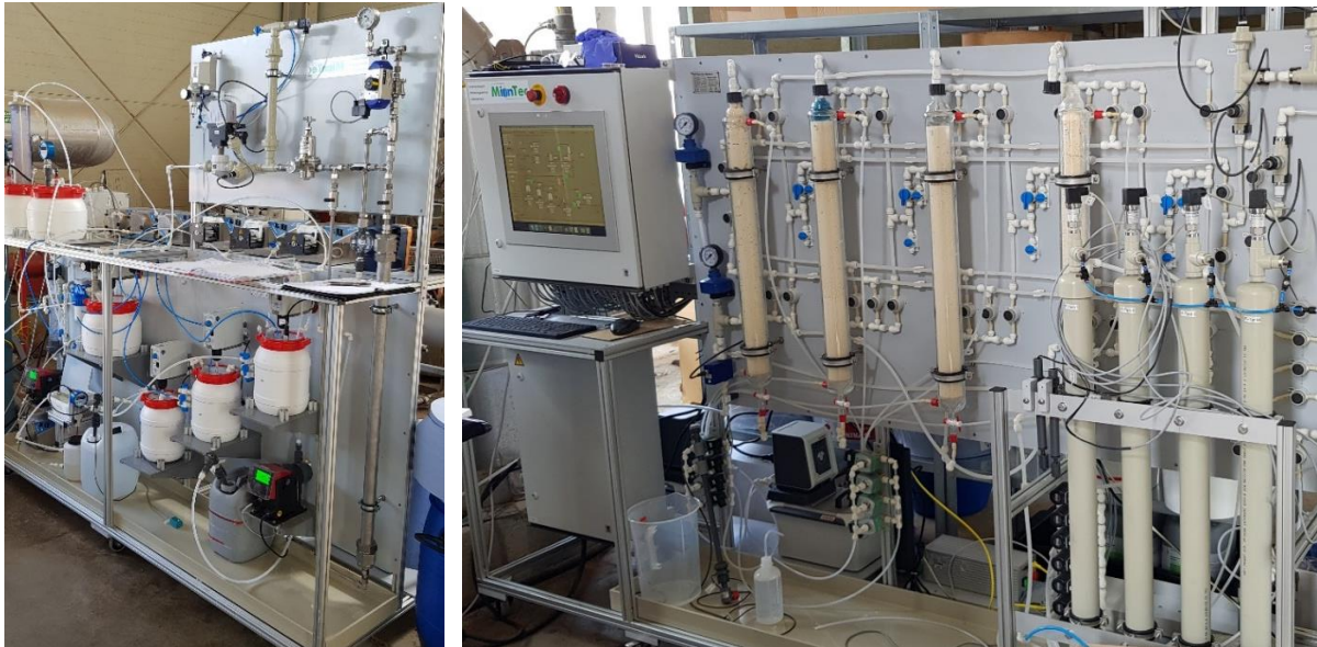
Figure 10 : (à gauche) Installation pilote d'extraction du lithium, unité de prétraitement de la saumure. (à droite) Installation pilote d'extraction du lithium, unité DLE.
